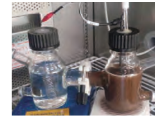
電気微生物培養系 2槽式培養系を用いて、電気を用いて微生物による汚染物の分解促進あるいは汚染水からの電気の取出し(発電)を行っている。
