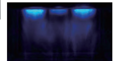
化学ルミネッセンスによる超音波化学反応場の可視化 Chemical luminescence in a sonochemical reactor
