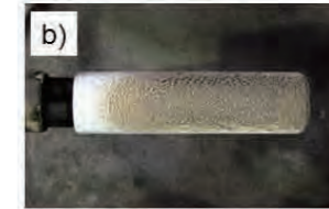
b) 灰付着炉にて30分曝露後の伝熱管試料外観写真 b) Picture of ash deposition after 30 min
