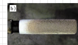
b) 灰付着炉にて30分曝露後の伝熱管試料外観写真 b) Picture of ash deposition after 30 min
