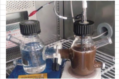
電気微生物培養系 2槽式培養系を用いて、電気を用いて微生物による汚染物の分解促進あるいは汚染水からの電気の取出し(発電)を行っている。 Electromicrobial culture system Studies are carried out on the electrochemical enhancement of pollutant degradation by microorganisms or the microbial electric generation from polluted water, using two-chamber bioelectrochemical culturing system.
