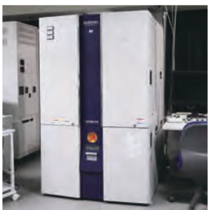
インレンズSEM HITACHI SU9000 In-lens SEM HITACHI SU9000
