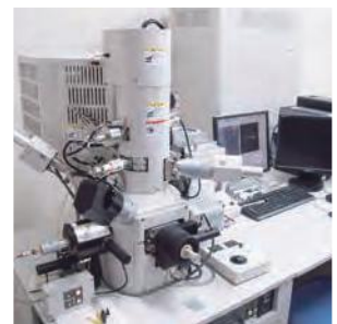
集束イオンビーム加工機 FB-2100 (FIB) Focused ion beam sample preparation system FB-2100
