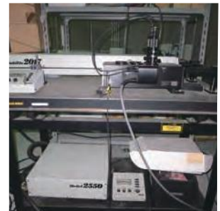
1成分レーザドップラー流速計測装置 Laser doppler velocimeter for one velocity component
