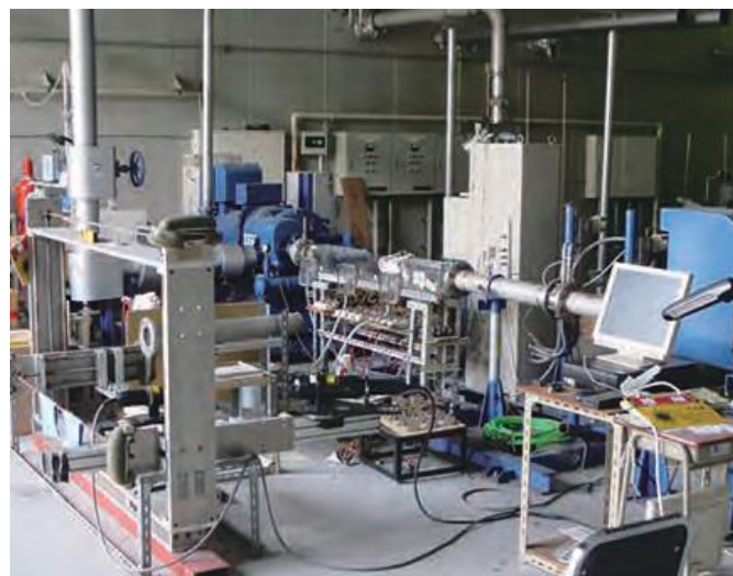
超音波霧化による圧縮空気冷却機能装置付属の小型圧縮機 (研究所共通機器)
