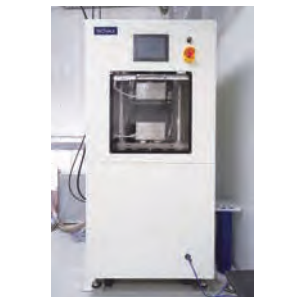
ナノインプリント サイヴァックス X500 Nano inprint equipment SCIVAX X-500
