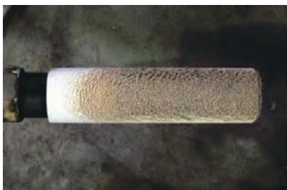
灰附着炉にて 30 分曝露後の伝熱管試料外観写真 Picture of ash deposition after 30 min
