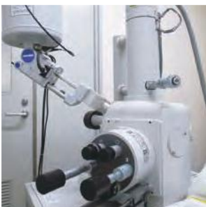
エネルギー分散型X線分析装置付走査型電子顕微鏡 Scanning electron microscope with energy dispersive x-ray spectroscopy
