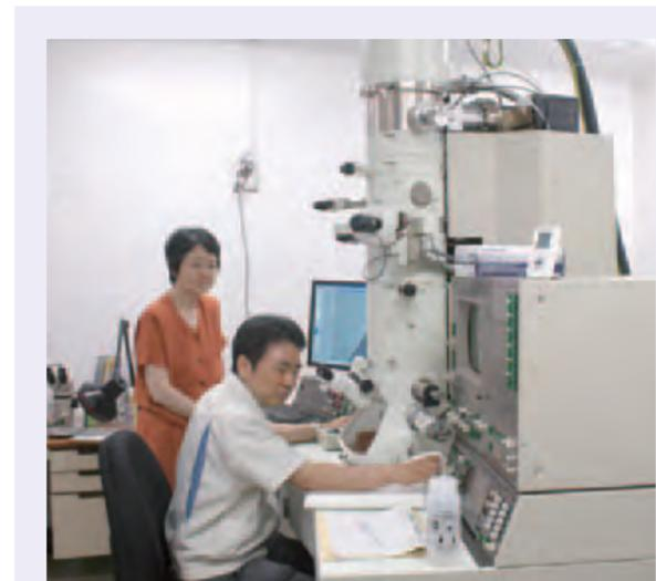
実験で作製した、ナノ・カーボン薄膜を透過型の電子顕微鏡で観察しているところ。本当にできているのか、思っていたようにできているのか、ナノサイズなので肉眼ではわからないため、いちばんドキドキする瞬間です。
