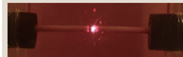
SPP法により、金属ナノ粒子が電解質溶液中に生成される。高分子干渉材を用いることなく凝集(原子などが多数集まって塊となること)せず、粒径20nm以下任意のナノ粒径の状態を長期保つことが可能。
