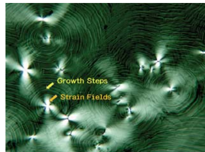
図 1 成長丘と内部欠陥の対応、Strain Fileds は混合転位の歪み場に対応。偏光顕微鏡像。
