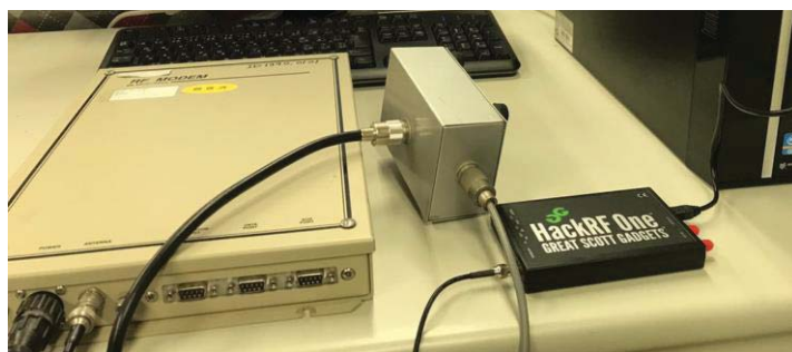
図4: ソフトウェア無線機による復調システム
